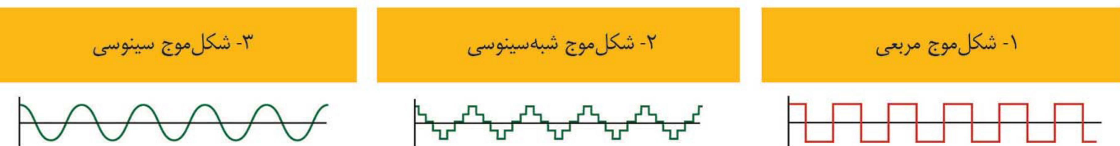
درمورد مصارف قدرت کم و متوسط و دستگاه‌های غیرحساس، شکل موج‌های مربعی یا شبکه‌سینوسی تا اندازه‌ای قابل قبول است. برای مصارف قدرت زیاد و دستگاه‌های حساس شکل موج سینوسی یا نویز پایین لازم است.
